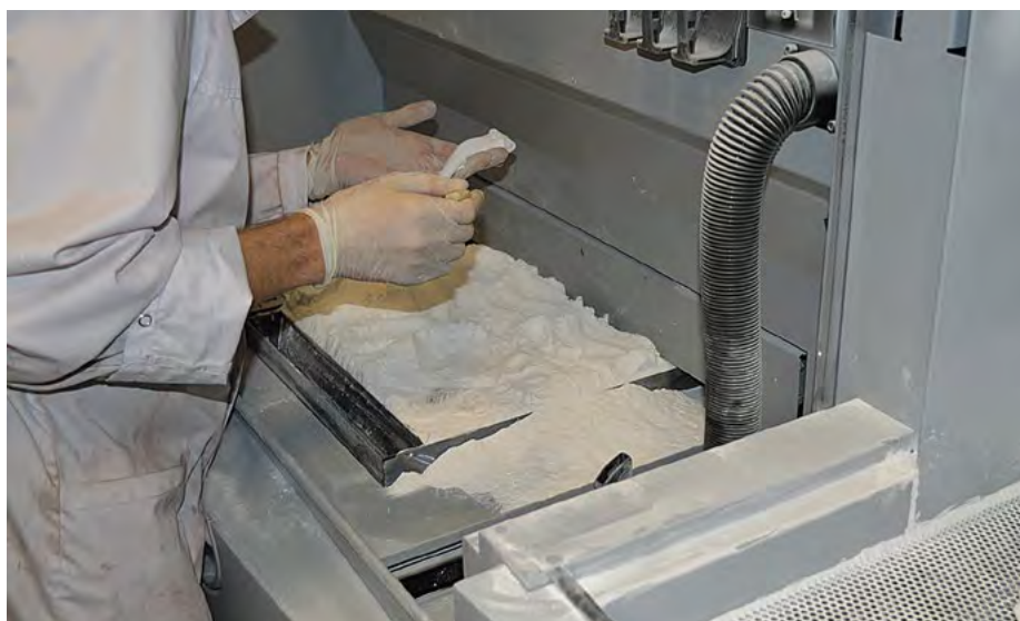
Рис. 6. Извлечение из принтера 3D-объекта и перенос его в камеру для отверждения.
