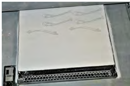
Рис. 4. Процесс 3D-печати – начальный этап.
