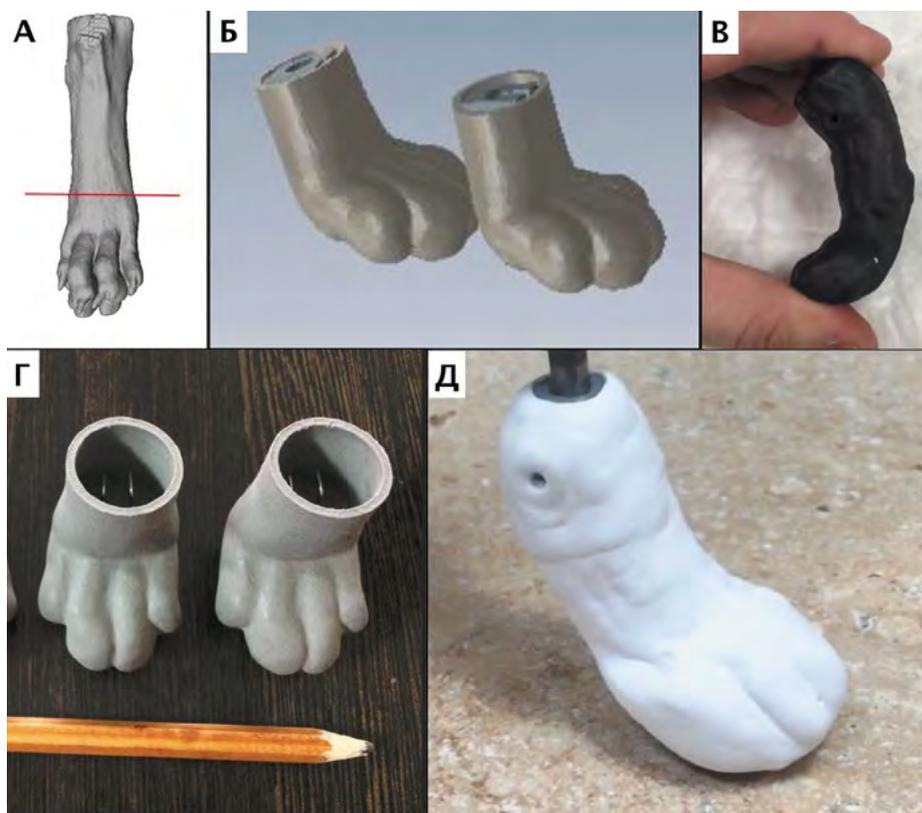
Рис. 3. А, Б - индивидуальные цифровые 3D-модели лап и напечатанные на их основании прототипы (В, Г, Д).
